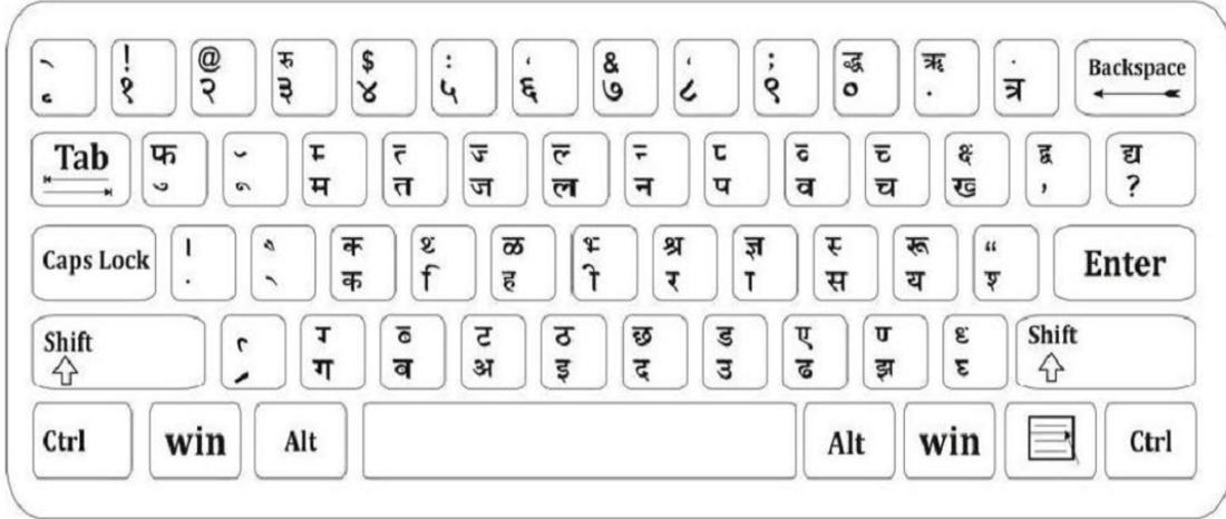
चित्र - 5 : रेमिंगटन क्लासिक कुंजीपटल के ले-आउट का एक चित्र
